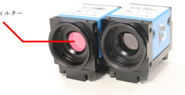
IR カットフィルター有りモデル（左）と無しモデル（右）
