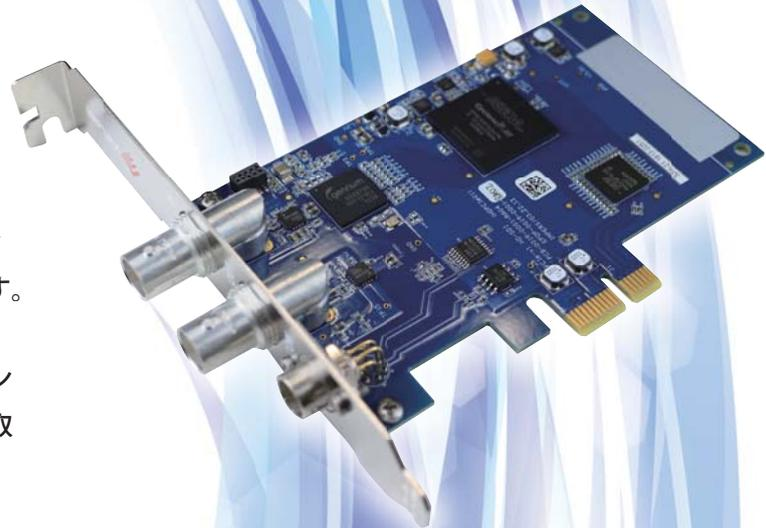
IMPERX 社の VCE-HDPCIe01 は、HD-SDI 信号を簡単にデスクトップパソコンへ取り込める HD-SDI キャプチャーボードです。HD-SDI 出力機器からの画像を取り込むことができます。インタフェースは PCI-Express を採用し、高速インテリジェント DMA とシステムメモリの効率的な利用でリアルタイムの取り込みを可能にしました。
