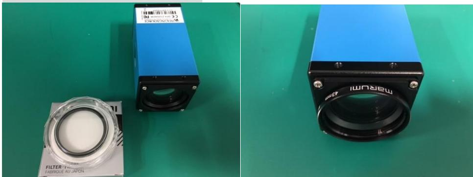
写真 1: 治具(型番 FA-Z3/43x0.75)付き電動ズームカメラとクローズアップレンズ ACNo.2~5(左)
