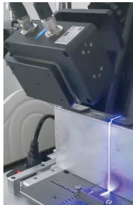
独立型ハードボックスバッテリーセルは、バッテリーボックスに組み込む前に検査
