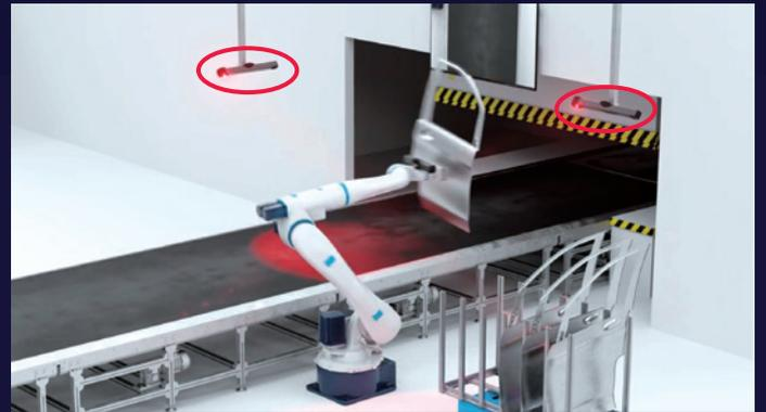
ドアのような大型ワークも高精度に3D計測
