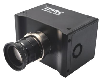
imecのIMEC-SSシリーズは、CMOSイメージセンサ上にライン状に配列した分光フィルタを搭載しています。可視近赤外域VNIR470～900nm（150バンド）と近赤外域NIR600～970nm（100バンド）のモデルがあります。
