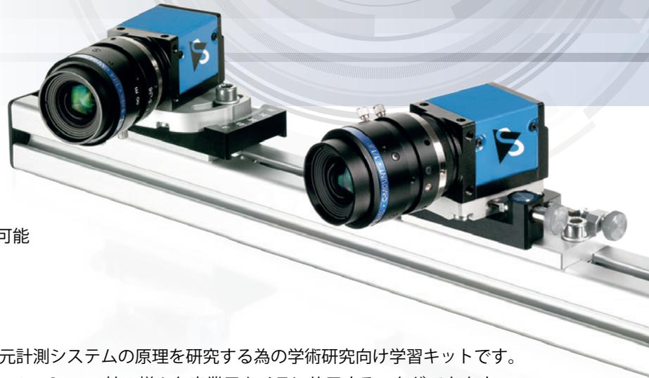
IC3D 3次元計測ラーニングスターターキットは、3次元計測システムの原理を研究する為の学術研究向け学習キットです。このステレオカメラシステムは柔軟性が高く、The Imaging Source社の様々な産業用カメラに使用することができます。また、カメラの距離と角度を変更することで、新しい作業距離と被写界深度に簡単に調整できます。
