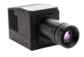
imec の IMEC-SS-SWIR は、InGaAs イメージセンサ上に分光フィルタをライン状に配列し、赤外線短波長域 SWIR1100 ~ 1650nm を 100 バンドで取得可能なモデルです。ピエゾ駆動の高精度スキャン機構が内蔵されており、別途スキャニングステージを用意する必要がありません。高精度・高速スキャナを採用することで、短時間で高精度のデータ取得が行えます。また、ファンとペルチェ素子 (TEC) によるアクティブクーリングとソフトウェア処理を組み合わせることで、高い SN 比を実現しました。
