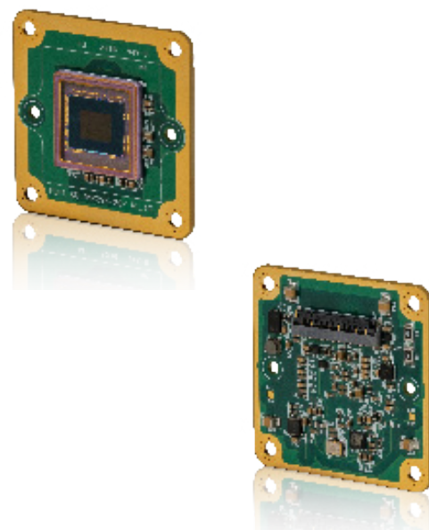
22-Pin シングルボードカメラモジュール
