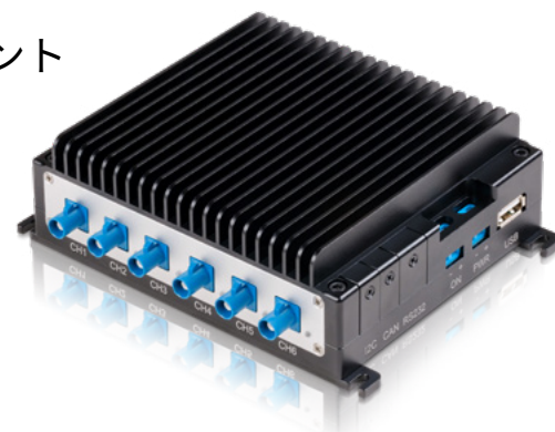
NVIDIA Jetson Xavier NX向け、 6ch FPD-LinkIIIキャリアボード
