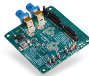
MDSER-FPD-2CH： Jetson Nano/Xavier NX向け、 FPD-LINKカメラ用デシリアライザー2ch
