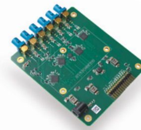
MDSER-FPD-6CH： AGX開発キット向け、 FPD-LINKカメラ用デシリアライザー6ch
